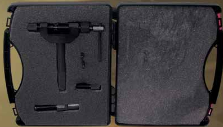
Cortador y remachador cadena distribución
